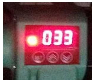
Калибровка регулятора температуры проводится на заводе-изготовителе и, при необходимости, при ежегодном обслуживании в авторизованном сервисном центре Robu. Самостоятельная калибровка возможна только при наличии соответствующих знаний, навыков и профессионального измерительного оборудования (проверенного цифрового контактного термометра). Для самостоятельной калибровки регулятора температуры обратитесь в сервисный центр Robu для получения соответствующей инструкцией.
