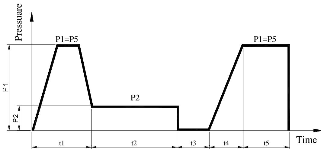
**t1:** Время оплавления стыка до образования грата (симметричного буртика)
